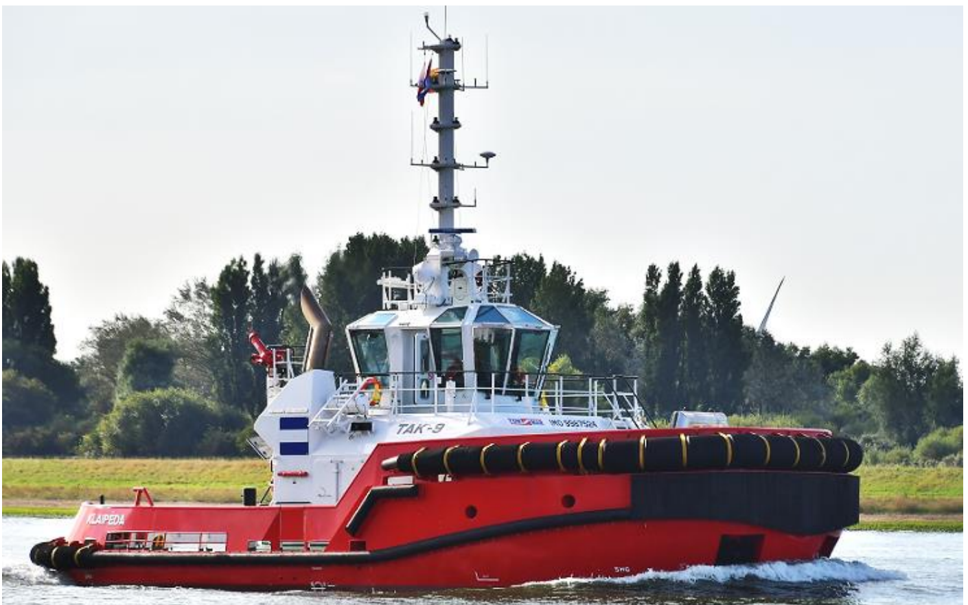
TAK-9, IMO 9987524 (NB-320), Tug, 263 GT, 28-6-2024 opgeleverd door Damen Song Cam Shipyard, Vietnam (513629) als TAK-9 aan Damen Workboats B.V., vlag: St. Vincent and Grenadines (8B6559), in beheer bij Damen Service B.V. 210 NT, 89 DWT. 22,81 (20,18) x 11,40 x 4,40 x 3,500 meter. 5.168 EPK, 3.804 kW, 2 x 12 cyl, 4 tew, 170 x 215, 1.800 rpm., Caterpillar 08938/E2 BV, Caterpillar Inc., Tianjin, China. 30-8-2024 gearriveerd te Rotterdam, Waalhaven a/b m.s. HAPPY RIVER. 9-2024 overgedragen aan Towmar Baltic UAB, Klaipeda, vlag: Litouwen (LYCJ). 14-9-2024 vertrokken naar Klaipeda, 18-9-2024 te Klaipeda. (Foto: Henk van der Heijden, 14-9-2024, Maassluis).
