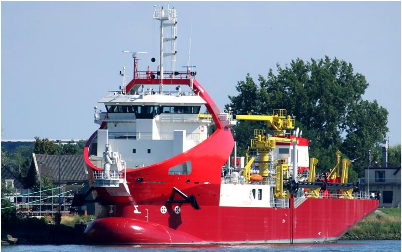
SAMSON, IMO 9924168, Hopper Dredger, 4.465 GT, 6.600 DWT, 9-2020 in aanbouw onder bouwnummer IHC HOLLAND CO1312, 31-7-2024 opgeleverd als SAMSON aan Jhonlin Marine Transport, Jakarta, vlag: St. Vincent and Grenadines (J8B6576). 87,25 (79,10) x 19,60 x 7,50 x 6,800 meter. 4.150 m 3 . 12,5 kn. 4,975 kW. 7-8-2024 vertrokken naar Kaapstad. (Foto: Pieter Inpijn, 10-7-2023, Alblasserdam).
