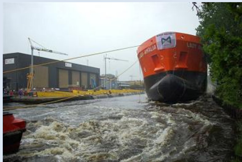
LADY AMALIA 9624847, 31-5-2012 om 11:00 uur te water gelaten bij Groningen Shipyards B.V., Waterhuizen onder bouwnummer 130, de sleepboten WATERLELIE en GYAS van Wagenborg Sleepdienst B.V. assisterden daarbij, in aanbouw voor Lady Amalia B.V., Delfzijl, in beheer bij Wijnne Barends B.V., 4e schip uit de Sea-River serie, roepsein PCNV, 2.544 BRT, 84,98 x 13,35 x 4,90 x . meter, 1.015 EPK, 10 kn. Foto's: B.H.F. Spruit.
