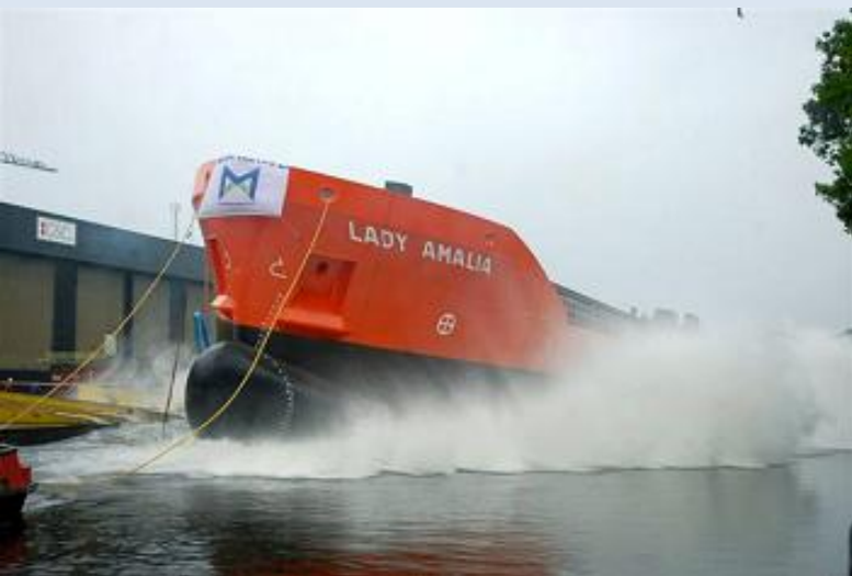
LADY AMALIA 9624847, 31-5-2012 om 11:00 uur te water gelaten bij Groningen Shipyards B.V., Waterhuizen onder bouwnummer 130, de sleepboten WATERLELIE en GYAS van Wagenborg Sleepdienst B.V. assisterden daarbij, in aanbouw voor Lady Amalia B.V., Delfzijl, in beheer bij Wijnne Barends B.V., 4e schip uit de Sea-River serie, roepsein PCNV, 2.544 BRT, 84,98 x 13,35 x 4,90 x . meter, 1.015 EPK, 10 kn. Foto's: B.H.F. Spruit.
