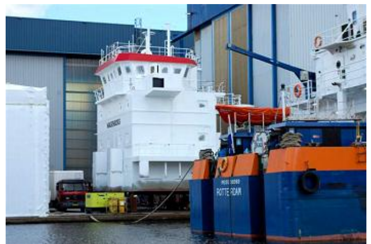
JOHAN VAN VEEN 9098971, hopperzuiger/splijtbak van Van Oord Overig Materieel I B.V., Rotterdam, bouwjaar 2007, 827 BRT, opbouw (foto links) op de kant bij Kon. Niestern Sander te Delfzijl tijdens een verbouwing, er wordt een extra verdieping opgebouwd, 14-4-2012 gearriveerd te Delfzijl vanaf Algeciras achter een sleepboot. Rechts de opbouw van de in aanbouw zijnde EXEBORG. Foto's: B.H.F. Spruit, 13-5-2012.
