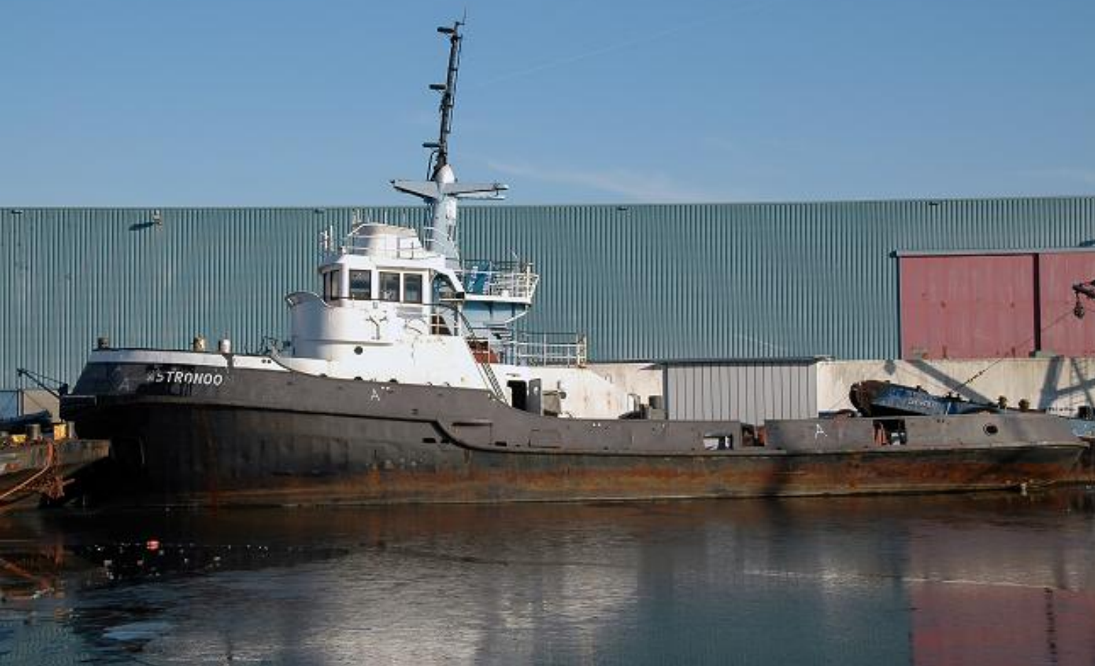
m.s. SCHOUWENBANK (1) 5315486 1960-1972 sleepboot PHKF Gebouwd 1960, N.V. Scheepswerven v/h H.H. Bodewes, Millingen (559) 183,34 BRT 30,38 x 7,55 x 3,81 x 2,998 meter. haven- kustsleepboot, trekkracht 15,5 ton, 13 kn. 1.240 APK, 2 x 8 cyl, 4 tew, 220 x 280, aandrijvend elk 1 generator, gekoppeld aan 1 elektromotor op 1 schroef, Deutz BA8M528, Klöckner-Humboldt-Deutz A.G., Keulen, generators en elektromotor: Smit Slikkerveer.
