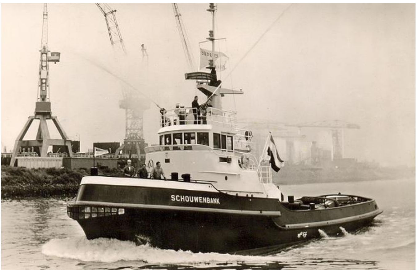
m.s. SCHOUWENBANK (1) 5315486 1960-1972 sleepboot PHKF Gebouwd 1960, N.V. Scheepswerven v/h H.H. Bodewes, Millingen (559) 183,34 BRT 30,38 x 7,55 x 3,81 x 2,998 meter. haven- kustsleepboot, trekkracht 15,5 ton, 13 kn. 1.240 APK, 2 x 8 cyl, 4 tew, 220 x 280, aandrijvend elk 1 generator, gekoppeld aan 1 elektromotor op 1 schroef, Deutz BA8M528, Klöckner-Humboldt-Deutz A.G., Keulen, generators en elektromotor: Smit Slikkerveer.
