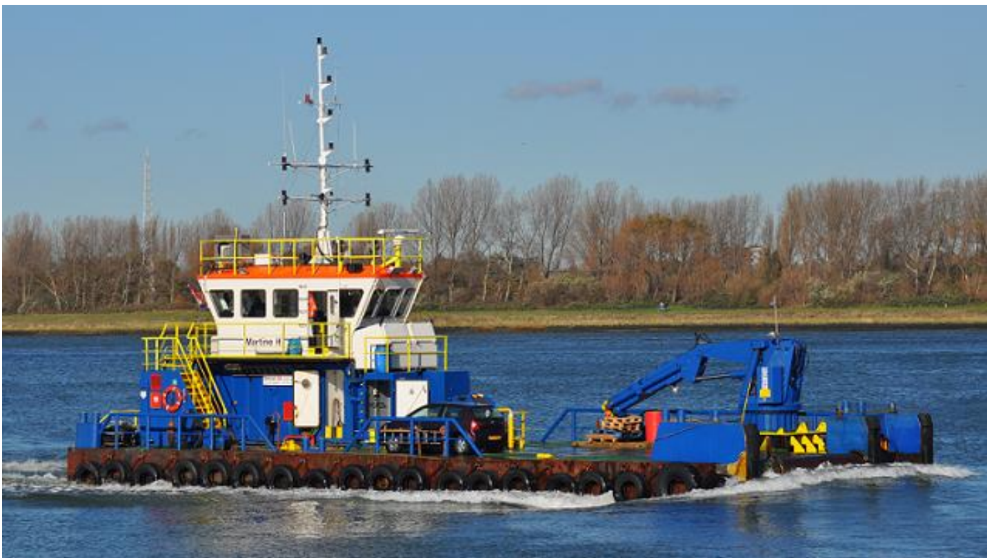
MARTINE H 8988777, 21-6-1993 opgeleverd door Scheepswerf Ravestein B.V., Deest (46) als ANTARCTICA. 147 BRT, 44 NRT, 20,49 x 9,75 x 2,41 x 1,800 meter, 936 EPK, 690 kW, Mitsubishi S6A. 2003 verkocht aan Stemat B.V., Rotterdam, herdoopt MARTINE H, roepsein PCSJ. 2012 thuishaven en vlag: Portsmouth-Dominica, roepsein J7CC6, 2012 herdoopt MARTIN, 29-4-2012 vertrokken van Rotterdam achter de sleepboot IKAR naar Tallinn.
