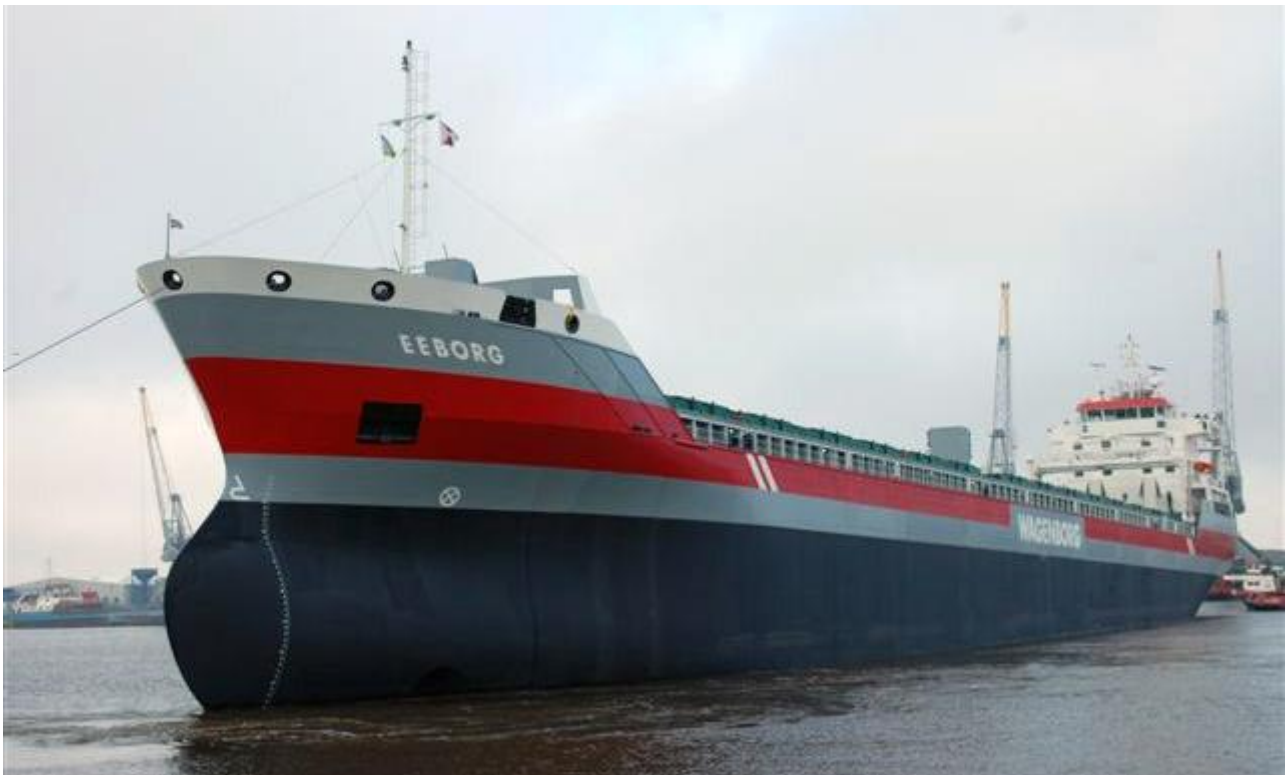
EEBORG 9568328, 27-10-2011 gedoopt EEBORG door mevrouw Aitkul Samakova en te water gelaten bij Koninklijke Niestern Sander B.V. te Delfzijl onder bouwnummer 843, 7.425 BRT, 144,56 x 15,87 x 11,15 x . meter, 4.500 kW, Wärtsilä 9L32C, 15 kn., roepsein PCNL, 3-1-2012 gepland vertrek van de werf, 10-1-2012 vertrokken van de werf, kompas gesteld en afgemeerd aan de Wagenborg terminal, 25-1-2012 proefvaart op de Eems, 26-1-2012 te Delfzijl opgeleverd aan Scheepvaartonderneming Eeborg B.V., Delfzijl, in beheer bij Wagenborg Shipping B.V., 28-1-2012 vertrokken van Delfzijl naar Liepaja om veevoer te laden voor Jorf Lasfar.
