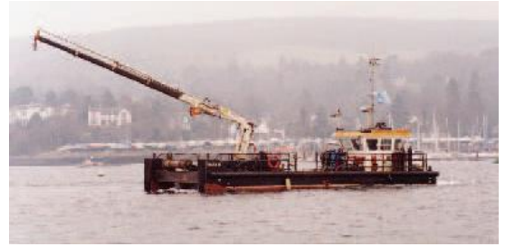
MARY M (foto rechts) Multi-Role Vessel MRV15, 5-1999 te water gelaten, 1999 opgeleverd, 15,82 x 7,42 x . x 1,200 meter, 500 PK, 2 x GM 671, trekkracht 5 ton, 8 kn.
