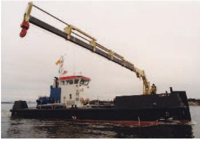
MARY M (foto rechts) Multi-Role Vessel MRV15, 5-1999 te water gelaten, 1999 opgeleverd, 15,82 x 7,42 x . x 1,200 meter, 500 PK, 2 x GM 671, trekkracht 5 ton, 8 kn.
