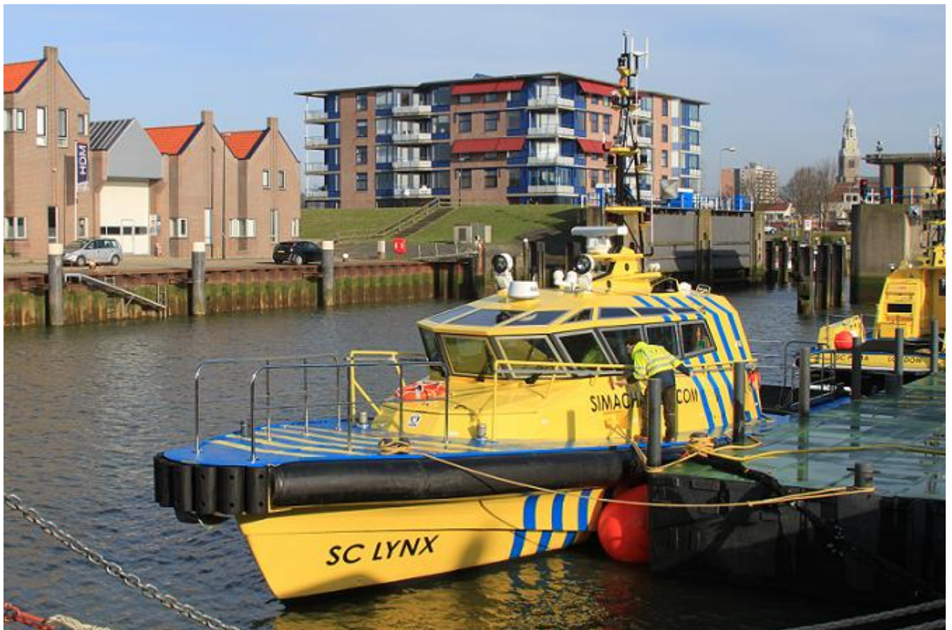
SC LYNX, MMSI: 235081661, crewtender, vlag: U.K., roepsein 2DSI9, gebouwd 2010, 29,55 BRT, 29,55 NRT, 18,00 x 5,60 x . x 1,000 meter, 650 PK, 478 kW, 2 x Volvo Penta, 2 x Rolls Royce/Kamewa waterjets type FF450S, 21 kn. Foto: SC LYNX, 16-2-2011, afgemeerd aan het in 2011 in gebruik genomen drijvende steiger in de haven van Maassluis.
