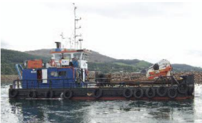
LESLEY M 8891053, werkschip, 1994 opgeleverd door Cosens Engineering & Co., Portland als MCS MENNO aan Maritime Craft Services (Clyde) Ltd., U.K., 135 BRT, 75 NRT, 20,00 x 9,00 x 2,30 x 1,200 meter, 761 EPK, 560 kW, Caterpillar, 9,7 kn. 2004 verkocht aan Gareloch Support Services (Plant) Ltd., Greenock-U.K., herdoopt LESLEY M.
