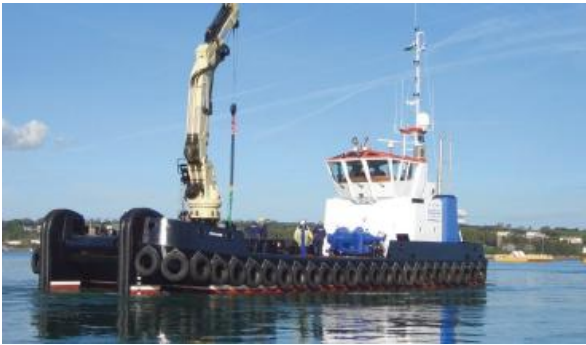
MARY M (foto rechts) Multi-Role Vessel MRV15, 5-1999 te water gelaten, 1999 opgeleverd, 15,82 x 7,42 x . x 1,200 meter, 500 PK, 2 x GM 671, trekkracht 5 ton, 8 kn.
