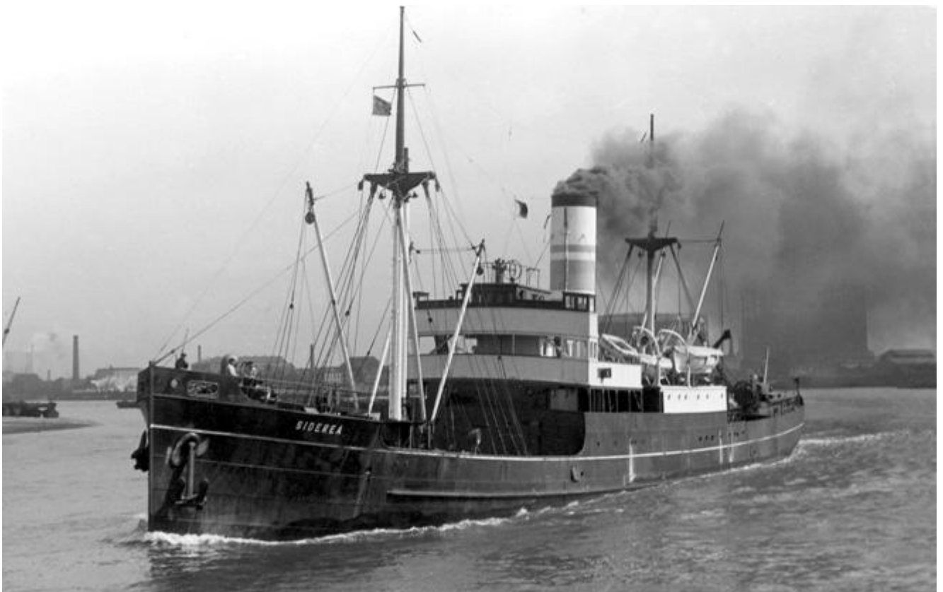
s.s. SIDEREA 5263346 1951-1957 vrachtschip TFCB Gebouwd 1919, N.V. Haarlemsche Scheepsbouw Mij., Haarlem (55) 86,49 (82,71) x 11,18 x 5,64 x 5,058 meter. 11,5 kn. 2 3-vuurs Schotse ketels: v.o. 381 m 2 , 12,65 kg., N.V. Mij. voor Scheeps- en Werktuigbouw "Fijenoord", Rotterdam.
