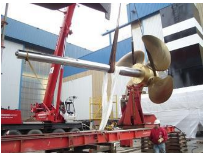
21 september 2011, plaatsen schroefas. 27 september 2011, plaatsen schoorsteen en hoofdmotor.
