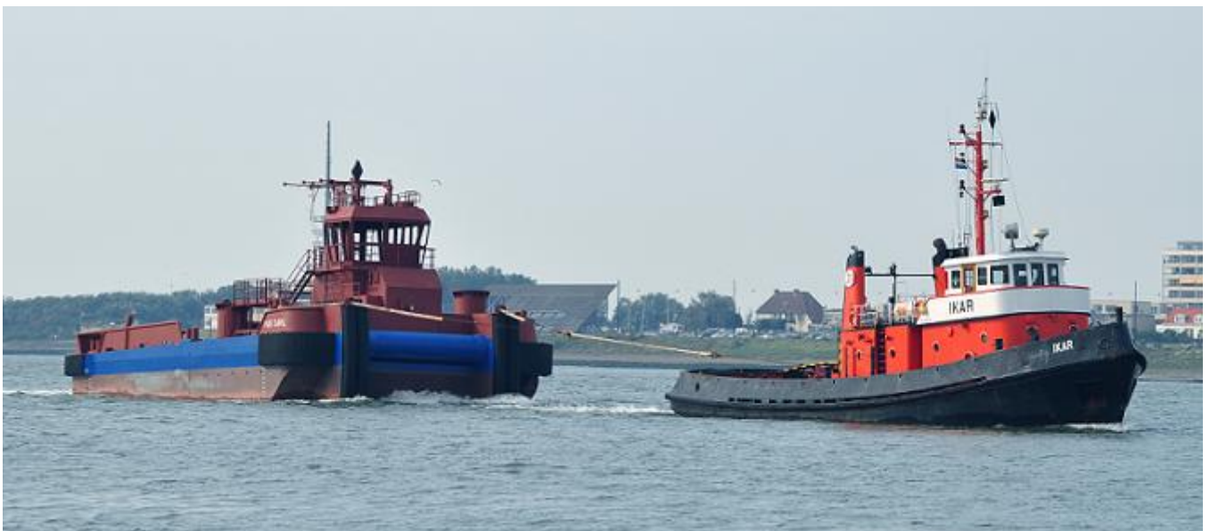
VOE EARL, MultiCat 2613, 2-9-2011 gearriveerd te Dordrecht achter de sleepboot IKAR, afbouw bij Damen Shipyards B.V onder bouwnummer DAMEN HARDINXVELD 571655, 302 BRT, 3.820 EPK, trekkracht 50 ton, 11 kn., 12-2011 geplande oplevering aan Delta Marine Ltd., Lerwick. (Foto: L. v.d. Meijden, Nieuwe Waterweg t.h.v. Hoek van Holland).
