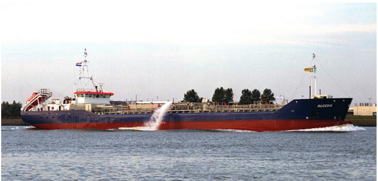
m.t. ALCEDO 9190315 1999-2000 tankschip PCFL / LXAU Gebouwd 1999, Scheepswerf en Machinefabriek Breko B.V., Papendrecht (9802), casco gebouwd door Scheepswerf Slob B.V., Dordrecht (406) 1.810 BRT 670 NRT 2.731 DWT 90,00 (87,70) x 12,30 x 6,30 x 4,265 meter.
