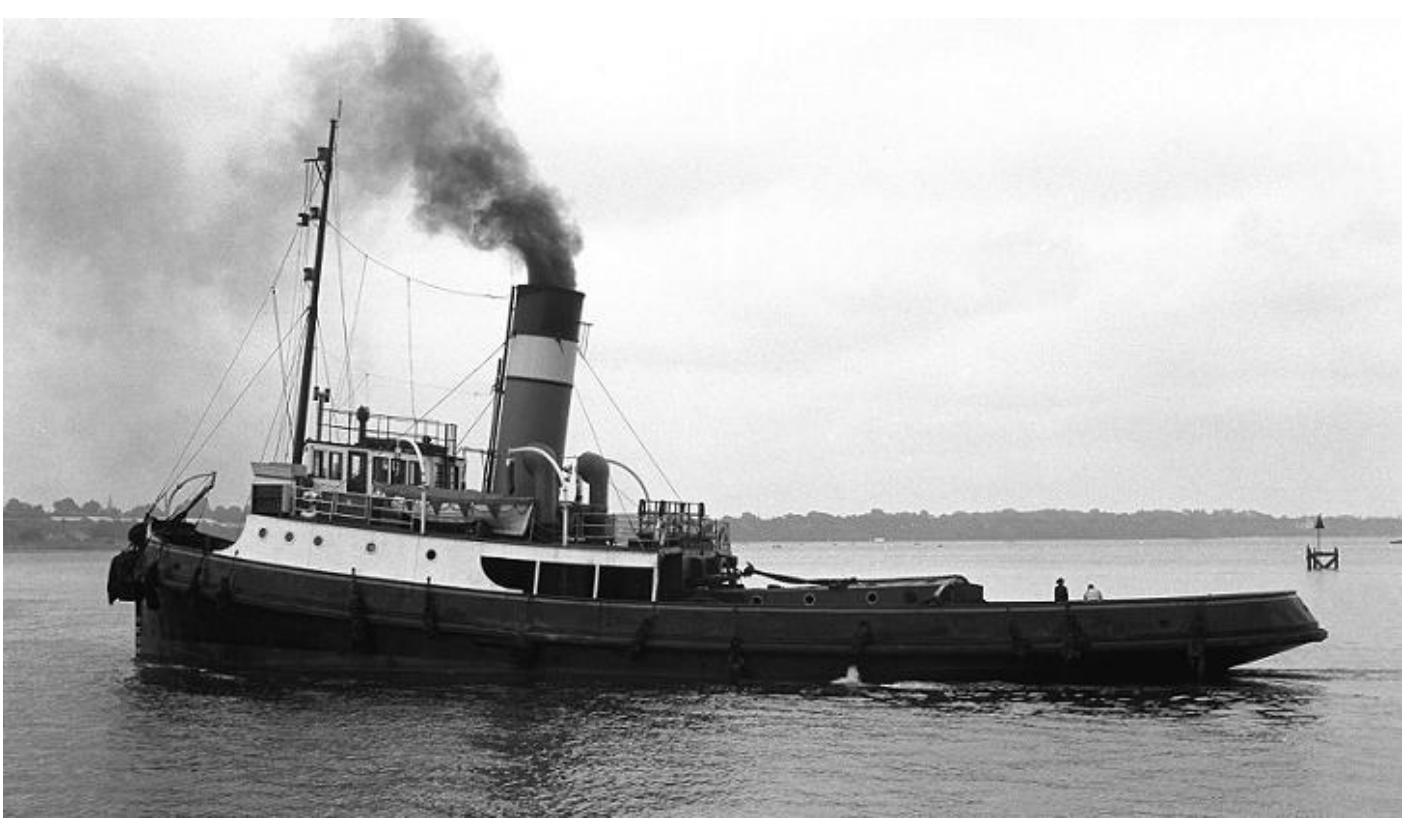
SLOYNE (2), 1928 opgeleverd door J. Crichton & Company, Saltney, Chester (456) als SLOYNE aan Alexandra Towing Company Ltd., Liverpool. 300 BRT, 32,13 x 8,24 meter. 11 kn. 900 IPK, T 3 cyl, Earle's Shipbuilding & Engineering Company Ltd., Hull. 1966 verkocht aan Charles Brand & Son Ltd., Liverpool, herdoopt LAVINIA. 1970 verkocht voor sloop aan Haulbowline Industries Ltd. voor sloop te Passage West. 5-1970 aanvang sloop te Cork. (Info o.a. Bill Harvey/clydemaritime. Foto: A. Duncan/T v.d. Zee).
