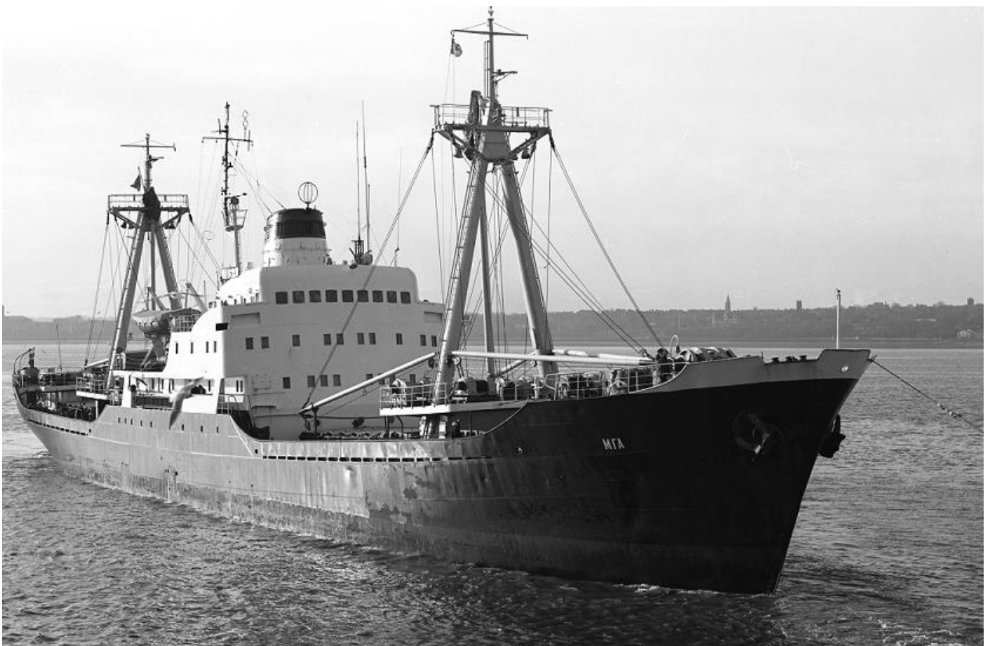
MGA, IMO 5233779, 1960 opgeleverd Schiffswerft "Neptun", Rostock () als MGA aan U.S.S.R., thuishaven: Tallinn. Roepsein UFHQ. 3.358 BRT, 1.738 NRT, 4.319 DWT. 103,99 (95,71) 14,41 x 7,90 x 6,560 meter. G 5.916 m 3 , B 5.635 m 3 . 242 ton bunkers, 12,5 kn. 2.500 EPK, 1.865 kW, 2 x 8 cyl, 4 tew, 365 x 550, vertraagd naar 1 schroef, Görlitzer Maschinenbau, Görlitz. Later opnieuw gemeten: 3.145 BRT, 1,628 NRT, 4.388 DWT. 10-9-1986 gearriveerd Gadani Beach om gesloopt te worden. (Foto NN-T. v.d. Zee, 11-1979).
