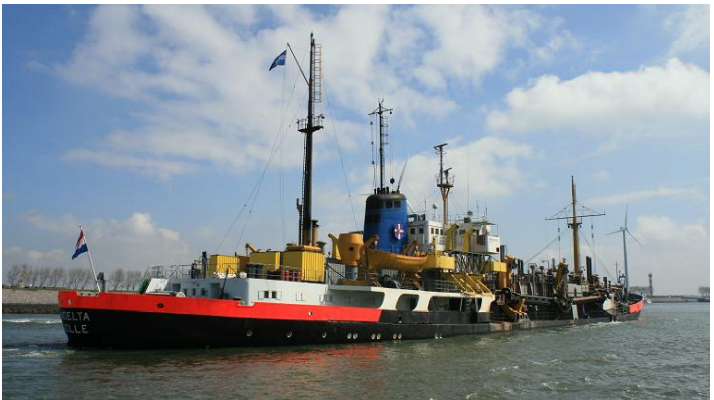
RIJNDELTA, IMO 5301849, hopperzuiger, 3-7-1959 kiel gelegd, 23-2-1960 te water gelaten, 1-9-1960 opgeleverd door Orenstein-Koppel und Lübecker Maschinenbau A.G. (535) als RUDOLF SCHMIDT aan Wasser & Schiffahrtsdirektion Aurich, Wilhelmshaven-B.R.D. Roepsein DBPP. Dieselelektrisch, 4.800 APK, 4 x Maybach Mercedes-Benz Motorbau. 1982 verkocht aan Bundesminister für Verkehr-WSV, Emden-B.R.D., in beheer bij Wasser-und Schiffahrtsamt Emden. 1984 verkocht aan Van Der Kamp Beheer B.V., Zwolle, roepsein PHFR, herdoopt RIJNDELTA. 14-12-2018 in de Merwehaven te Rotterdam. 19-12-2018 van de Merwehaven naar 's-Gravendeel en opgelegd. (Foto: T. v.d. Zee, 4-4-2011, Calandkanaal).
