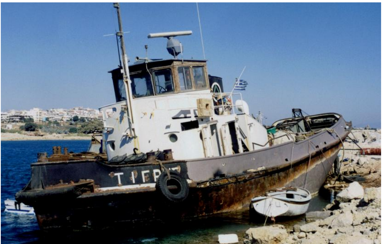
Dokken op z'n Grieks te Rhodos, de TIGRIS zo geparkeerd dat onderhoud aan schroef en roer mogelijk was, foto: T. Grootenboer, 9-2000.
