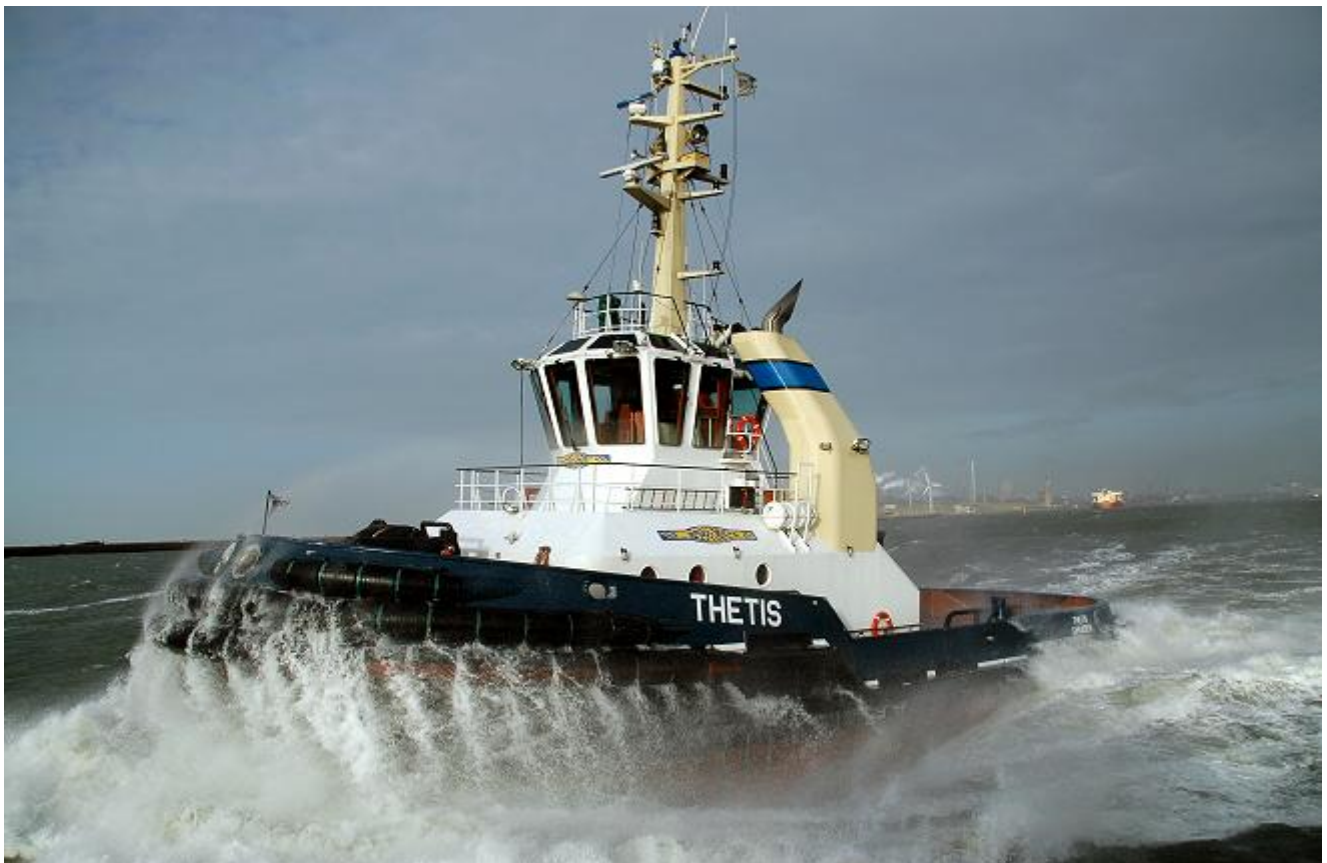
THETIS (3), IMO 9252527 (NB-99), Delta Azimuth Tug 2800, casco gebouwd door Apetin Yard, 8-3-2003 te water, afgebouwd bij I.H.C. Delta Shipyard (989), 21-6-2003 van Sliedrecht naar Schiedam voor het maken
